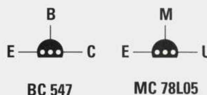
Fig.28 Connessioni viste da sotto del transistor BC.547 e del piccolo integrato stabilizzatore MC.78L05.
