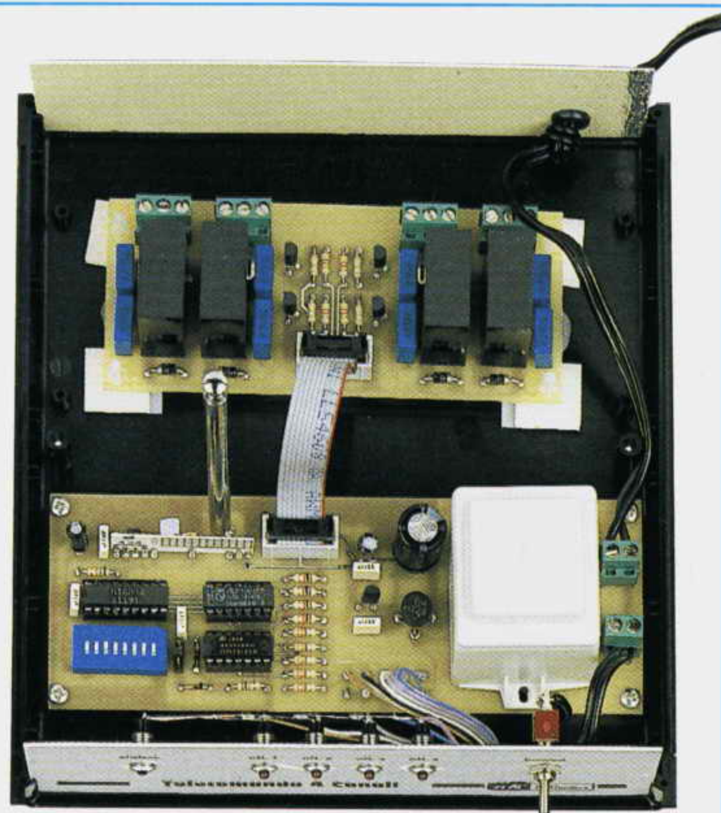
Fig.24 In questa foto potete vedere il circuito LX.1412 di fig.32 che si differenzia dal circuito LX.1411 perchè utilizza 4 relè. Alle morsettiere a 3 poli, poste vicino ad ogni relè, fanno capo i contatti A-B-C. A relè diseccitato risulteranno chiusi i contatti B-A e a relè eccitato risulteranno chiusi i contatti B-C (vedi fig.32).
